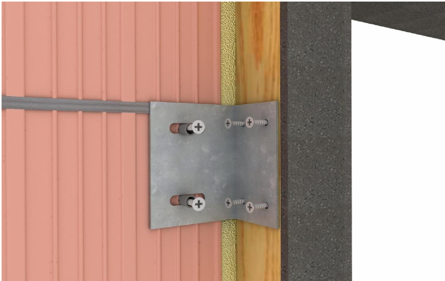
9. POSIZIONAMENTO DEL MONOBLOCCO NEL RELATIVO VANO, FISSAGGIO A MURO LATO ESTERNO MEDIANTE PIASTRE DI SOSTEGNO
