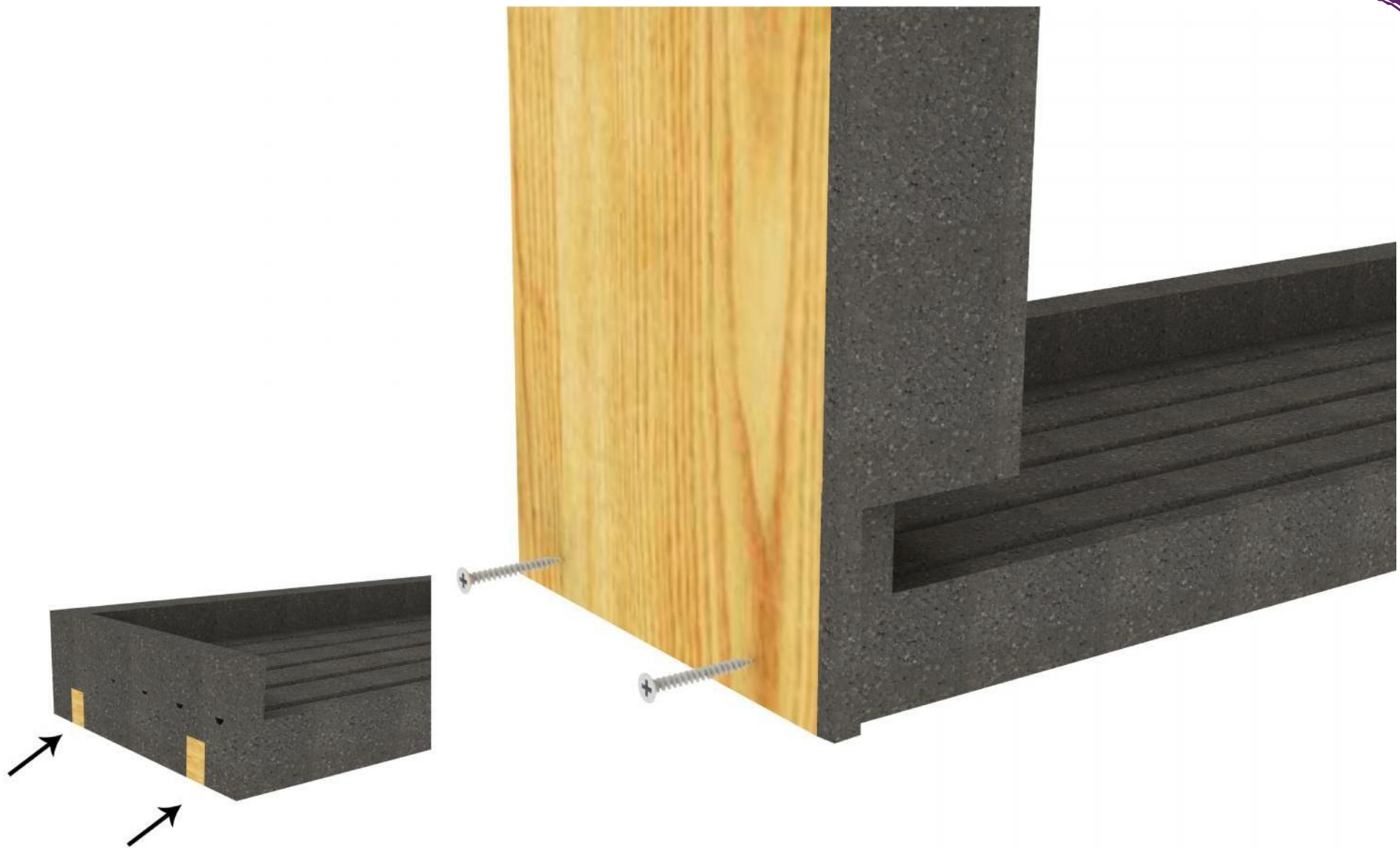
6. FISSAGGIO DEGLI ELEMENTI CON LE PREDISPOSTE VITI, IN CORRISPONDENZA DEI TRAVERSI IN LEGNO DEL SOTTOBANCALE
